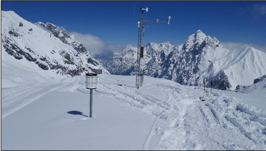
Abb. 24: Station Süd. Blick über das Reintal auf den Hochwannerkamm, im rechten Bildbereich ist das Gatterl erkennbar. Obwohl die Station weit abseits des Pistenbereichs installiert ist, durchkreuzen Skifahrer die Station und verfälschen die Schneehöhenmessungen.
