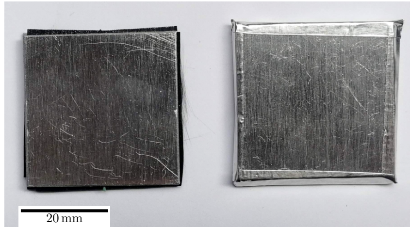
Abbildung 3.3: Probe zur Untersuchung der Kontaktentwicklung nach dem Pressen (links) und nach dem Abkleben mit Aluminiumklebeband zum Abdichten gegen Wassereintritt (rechts).
