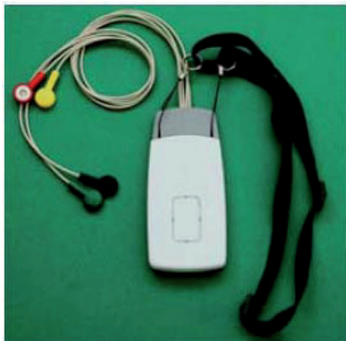
Bild 2 3-Kanal EKG mit automatischer EKG-Vorauswertung und Bewegungsmusteranalyse
