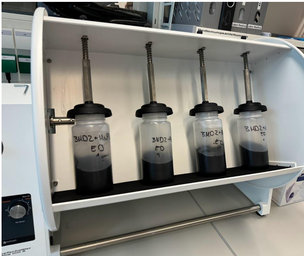
Abbildung 6: Überkopfschüttler mit Probenflaschen
