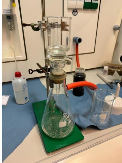
Abbildung 8: Aufbau Vakuumfiltration mit Membranfilter
