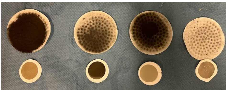
Abbildung 9: Filterpapiere mit Probenrückständen (Von links: Kontrollprobe, \text{KH}_2\text{PO}_4 , Kaolin, MinPlus)
