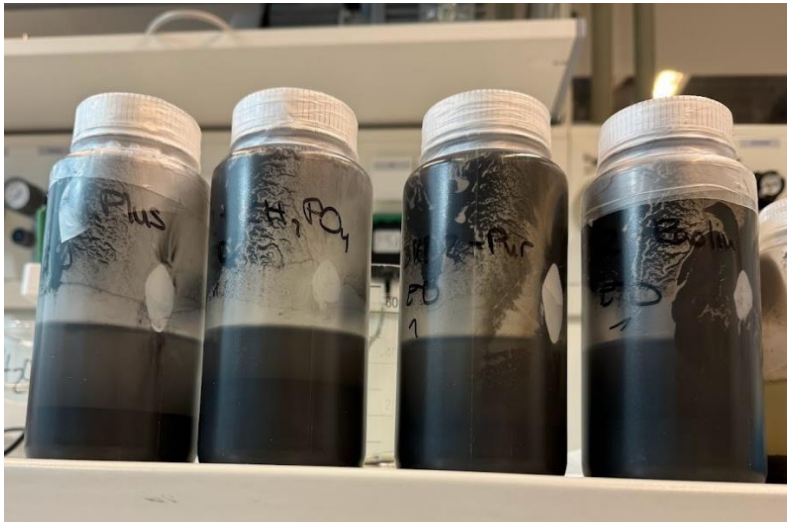
Abbildung 7: Proben nach Sedimentationszeit (Von links: MinPlus, KH 2 PO 4 , Kontrollprobe, Kaolin)
