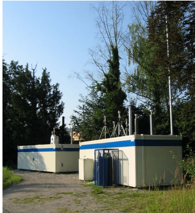
2 Messcontainer zur Aerosolcharakterisierung an der Baumgartnerstraße in Augsburg (Gelände der FH Augsburg)
