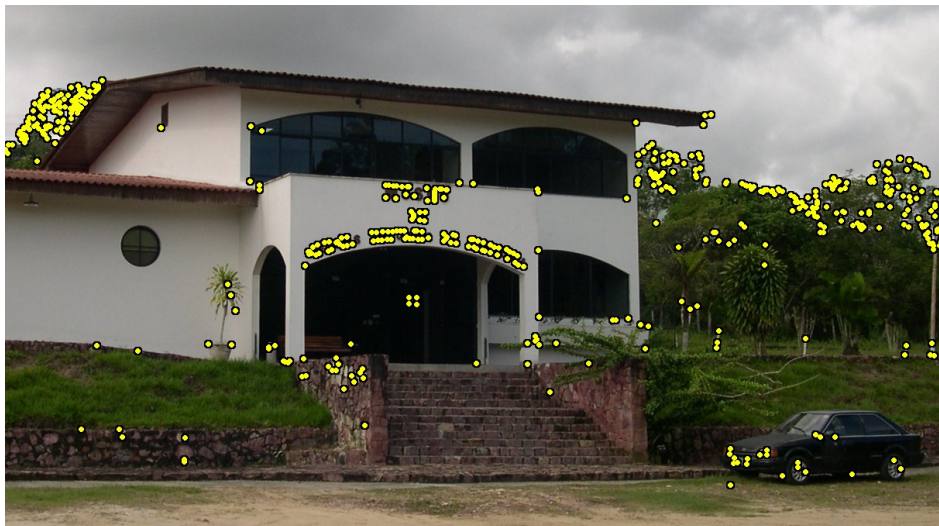
Abbildung 5.2: Es wurden die Harris-Merkmale mit den 500 höchsten Cornerness-Werten aus einem Foto extrahiert. Wie leicht zu erkennen ist, entspricht die Wahl der Merkmale oft nicht dem menschlichen Wichtigkeitsempfinden. In diesem Fall spricht der Detector zu sehr auf kleine Hintergrunddetails an. Teil des Problems ist die festgelegte Größe des Fensters.
