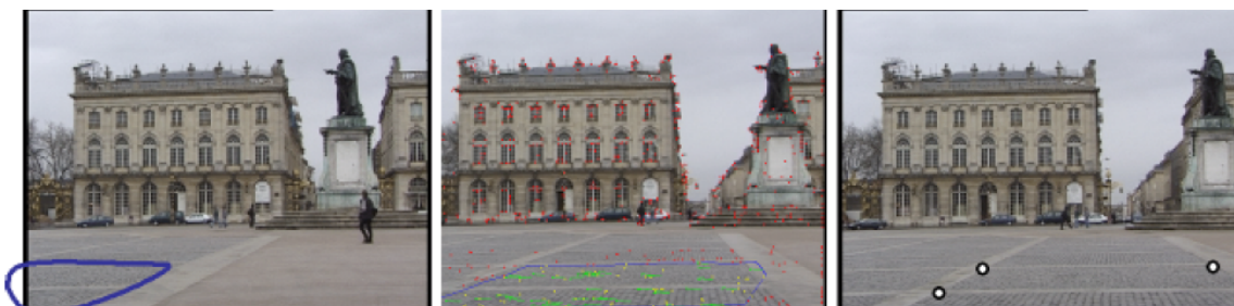
Abbildung 3.1: Die Initialisierung des Tracking-Systems der Universität Oxford ist besonders einfach. Zuerst wird ein Bildbereich markiert, der auf der zu verfolgenden Ebene liegen muss(links). Darauf setzt das Tracking ein (Mitte). Der Benutzer muss nun vier Punkte in rechteckiger Anordnung markieren(rechts). Damit ist die Initialisierung abgeschlossen. Entnommen aus [SFZ00] mit freundlicher Genehmigung von Gilles Simon.
