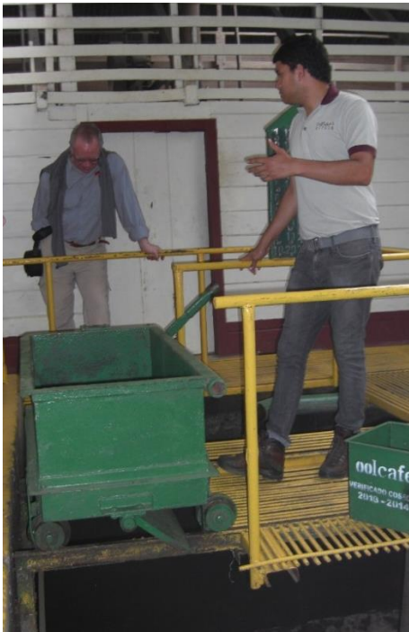
Abb. 7: Konstruktion über dem Becken zur Sortierung der Kaffeebohnen, in grün die Kippvorrichtung für die Fanegas
