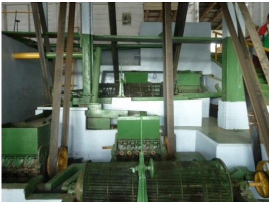
Abb. 5: Sortieranlage, die die Bohnen nach Größe in verschiedene Güteklassen sortiert Aufn.: B. Vordermeier
