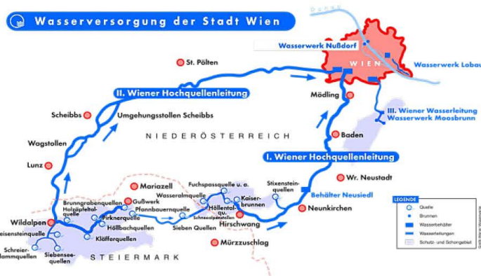
Abbildung 53: Der Weg des Wiener Wassers ( http://www.wien.gv.at/wienwasser/images/hql-grafik-gr.jpg )
