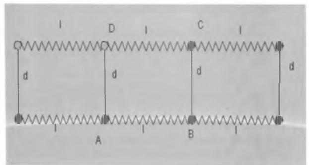
Abb. 1. Federmodell einer elastischen Latte
