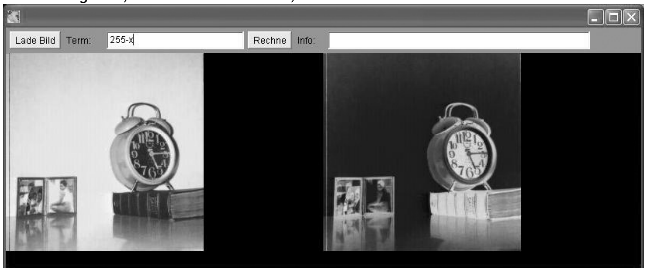
Abbildung 1: Das Java-Programm TermBild erlaubt die Eingabe einer Transformationsfunktion für Helligkeitswerte als Term.
