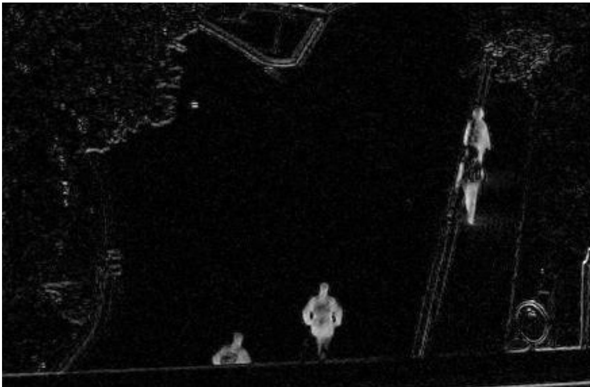
Abbildung 5: Ich habe kurz nacheinander zwei Bilder A und B aus meinem Bürofenster aufgenommen. Abgebildet ist der Betrag von 2 \cdot (A - B) . Der Radfahrer unten im Bild ist erkennbar schneller als die Fußgängerin rechts im Bild. Die Kanten längs des Bordsteins deuten auf ein leichtes Verwackeln der Kamera hin. Die unscharfen Dinge links und rechts oben sind hohes Gras und Büsche: Es war ein windiger Tag.
