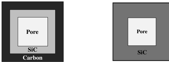
Fig. 3. a) Unit cell Y = P \cup SiC \cup C ; b) Pure SiC ceramics: Y = P \cup SiC
