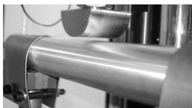
Bild 2: Probenumgebung beim Schlagversuch an Hohlprofilen.
