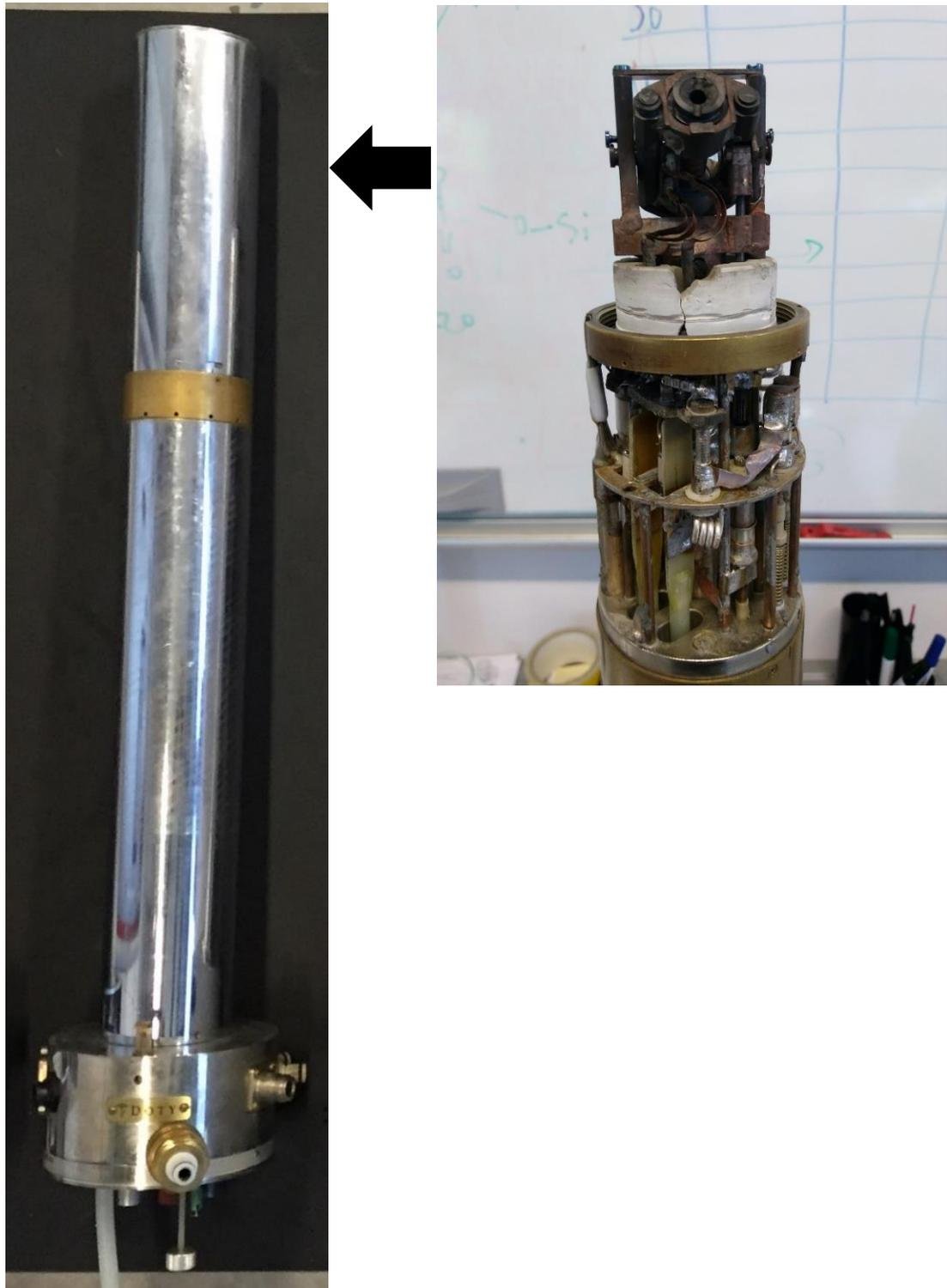
**Abbildung 5.1** links: Hochtemperatur MAS-Probenkopf von Doty Sci <sup>[118]</sup>. Rechts: Stator des Probenkopfes.
