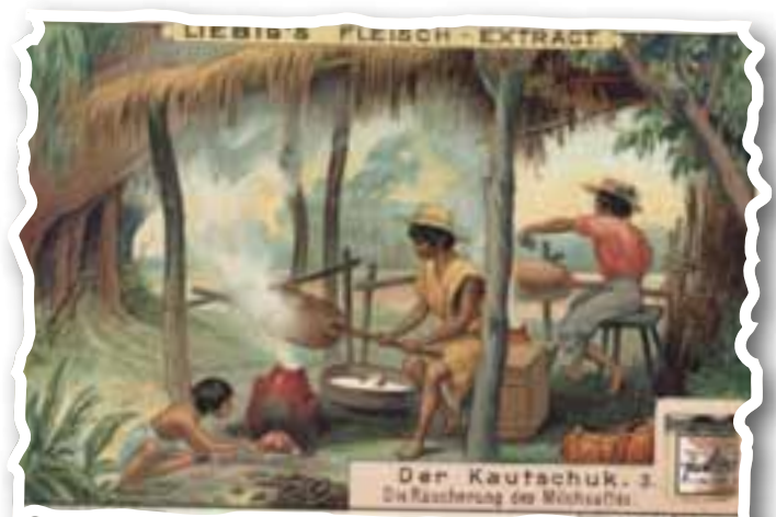
Für das Räuchern wird die urucurí-Nuss verwendet. Der Rauch bewirkt eine biologische Vulkanisation, die den Gummi haltbar macht. Sie ist ein funktionales Äquivalent zu der bei uns gebräuchlichen chemischen Vulkanisation.
