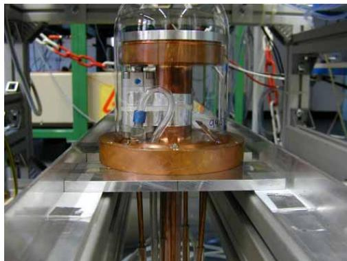
**Abb. E.3:** Probentisch muss linksbündig an der Schiene und bis zum Anschlag geschoben werden, damit die Probe auf der optischen Achse positioniert ist.
