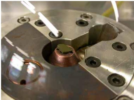
Gepresstes Stück  $\text{Cu}_2\text{S}$  auf dem Proben­träger
