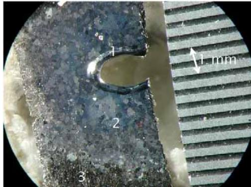
**Abb. 4.23:** Iridiumblech (Schmelzpunkt über 2700 K) mit Schmelzloch nachdem es einige Sekunden im Fokus des Strahlungssofens plaziert wurde. Details siehe Text.
