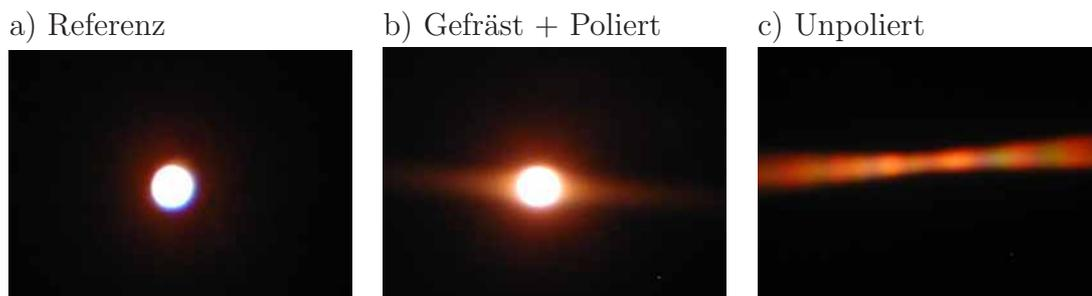
**Abb. 4.9:** An a) Referenzspiegel, b) poliertem und c) unpoliertem Spiegel reflektiertes Bild der mit Halogenlampe beleuchteten Lochblende.
