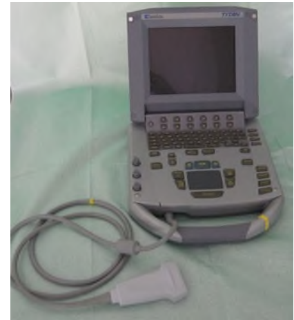
Abb. 2 ▲ Portables Sonographiesystem mit einem 7,5 MHz Linearschallkopf. Abmessungen: 30×28×8 cm, Gewicht: 3,5 kg (SonoSite TITAN, Fa. SonoSite® GmbH)
