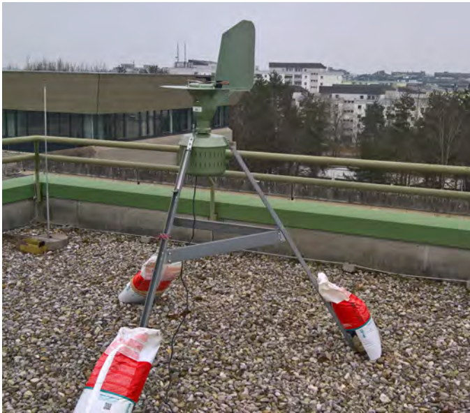
Abb. 2: Die Burkard Pollenfalle auf dem Dach des Gebäudes D an der Universität Augsburg ist seit Januar 2018 in Betrieb und misst seither kontinuierlich
