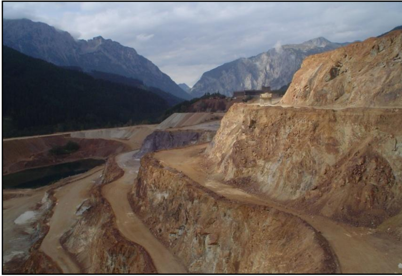
ABB. 32: VERSCHIEDENE SOHLEN (ABBAUTERRASSEN) AM ERZBERG (FOTO DURCH DIE VERFASSER)
